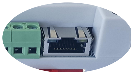
图 4、网口插入网线水晶头。
