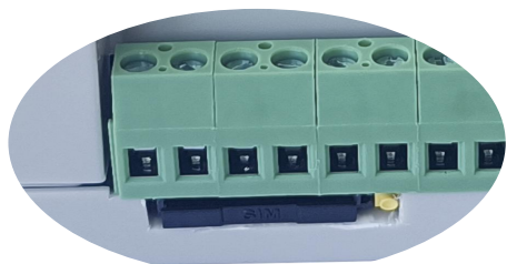
图 1、按下黄色按钮，取出 SIM 卡卡托。
