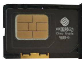
图 2、在卡托上放入 SIM 卡，并把卡托插入卡座。
